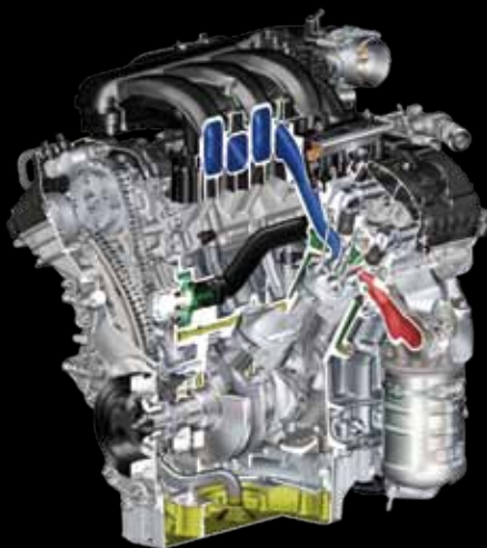
Двигатель CYCLONE™ 3.5 л 294 л.с. Ti-VCT
