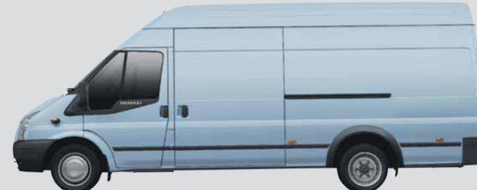
Длиннобазный фургон 'Jumbo' с двускатными задними колесами
