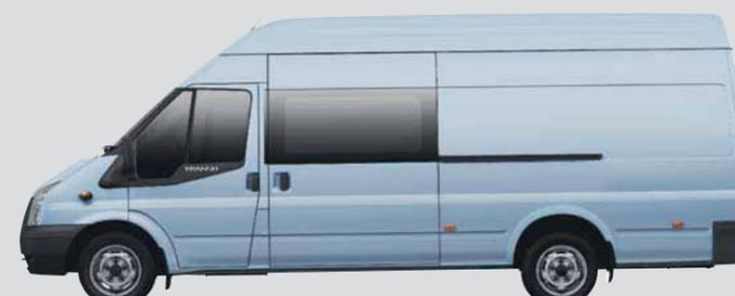
Фургон 'Jumbo' со сдвоенной кабиной и высокой крышей
