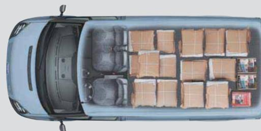
С тремя возможными вариантами высоты крыши (все цельнометаллические), среднебазный Ford Transit представляет собой очень практичный выбор. Максимальный объем грузового отсека в версии с высокой крышей - 8,85 м<sup>3</sup>, а грузоподъемность до 1761 кг.
