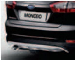
**3 Задний нижний диффузор бампера**
