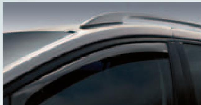
Уменьшают турбулентность и шум ветра, повышают комфорт поездок с открытым окном даже в дождливую погоду. 3-миллиметровое литое акриловое стекло высокого качества, конструкция которого оптимизирована для безупречной установки. В следующей таблице перечислены все комплекты, предлагаемые для передних и задних дверей.
